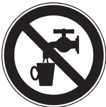
Abbildung 2: Zeichen für "Kein Trinkwasser", Quelle: DIN EN 806-2
