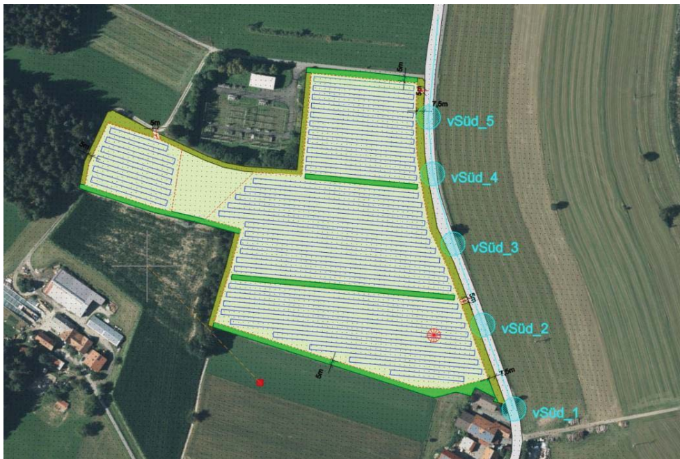
Abbildung 11: Blickpunkte (türkise Kreise) für die Prüfung auf Blendung durch Lichtreflexionen der PV-Anlage
