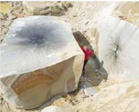
Während die tonnenschweren Granitblöcke im Bruch vielfach noch abgesprengt werden...
