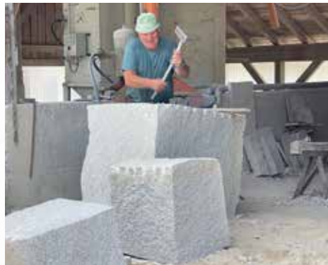
...wird in der Weiterverarbeitung der Stein mittels kleiner Eisenkeile gespalten.
